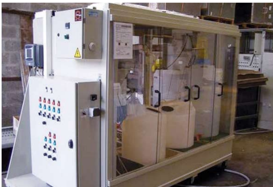
Pilote regroupant les technologies Hardtac Dense Sludge et Multiflow Turbomix.
